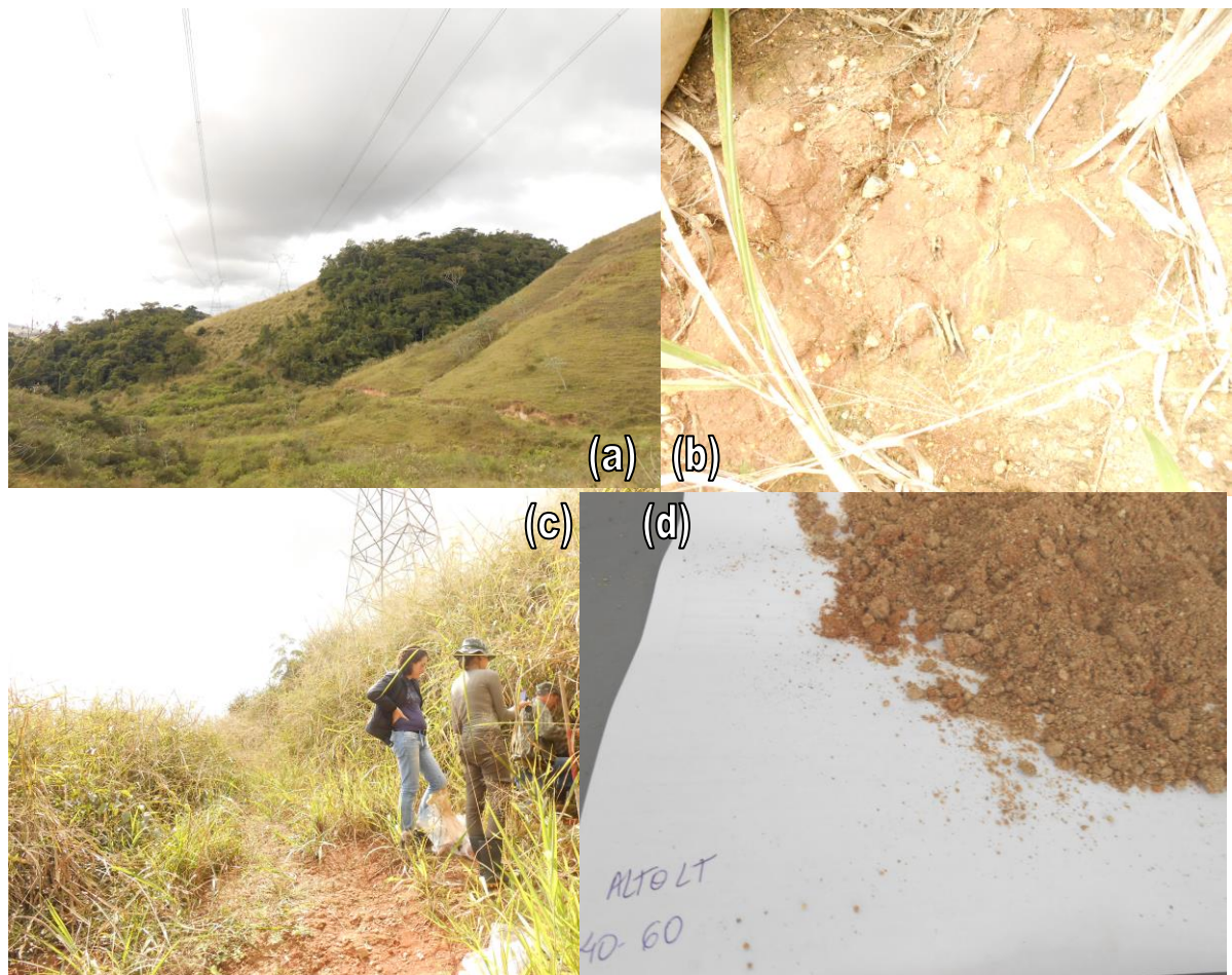
Figura 19: ARIE Floresta da Cicuta ponto Alto da Linha de Transmissão-LT: visão geral da área florestada (a) dividida pela linha de transmissão; detalhe do solo (b); coleta no acesso à linha de transmissão (c); amostra coletada na profundidade 40 a 60 cm (d) secando no laboratório.
