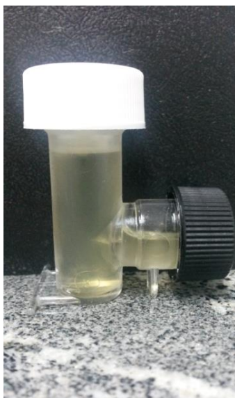
Figura 6 - Kit 1-2 test da empresa Biocontrol® para análise de Salmonella sp. após a incubação.
