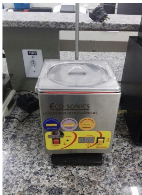
Figura 13 - Banho de ultrassom Eco-Sonics Ultronique Q1.8/40A
