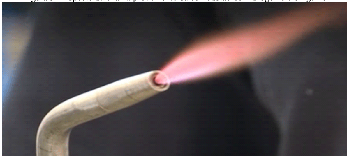
Figura 3 - Aspecto da chama proveniente da combustão do hidrogênio e oxigênio
